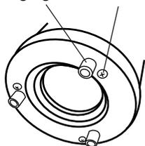
Les 3 vis moletées sont les vis de réglage tandis que les 3 vis à tête cruciforme sont les vis de blocage.
