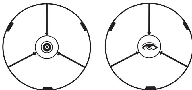
Les 2 miroirs sont alignés avec l'oculaire de collimation en place
