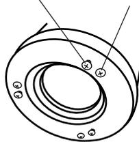
Les 3 vis longues à tête cruciforme sont les vis de réglage tandis que les 3 vis courtes à tête cruciforme sont les vis de blocage.
