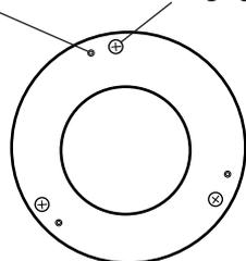
Les 3 vis à tête cruciforme sont les vis de réglage tandis que les 3 vis à tête à six pans creux sont les vis de blocage.
